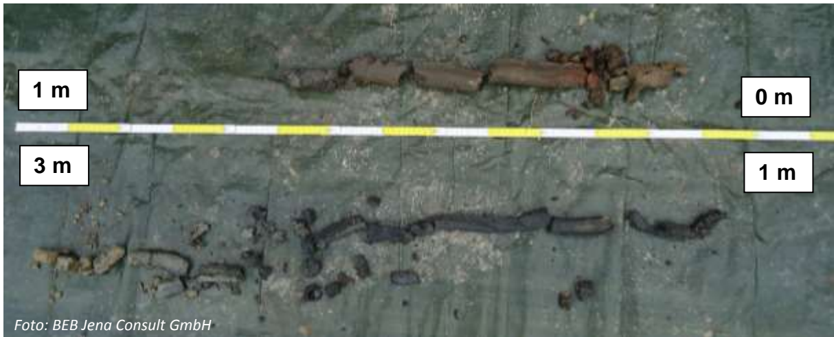
Abbildung 3: BS 11/16 mit deutlich erkennbaren, kontaminierten Bodenschichten.
